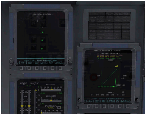
Abbildung 8.3: Die Anzeige des vertikalen und lateralen Profils
