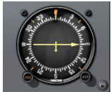
Abbildung 7.1: Das ADF in der Cessna 172
