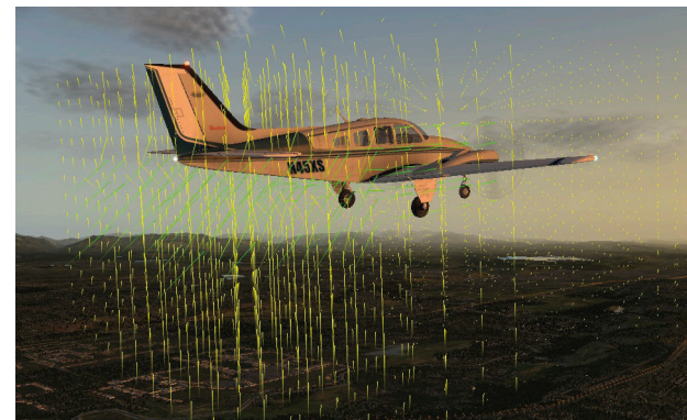
Abbildung 5.8: Das Strömungsfeld um eine Baron 58
