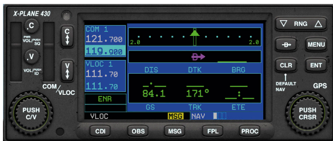
Abbildung 7.5.: Das X-Plane Garmin G430 GPS in der Cessna 172
