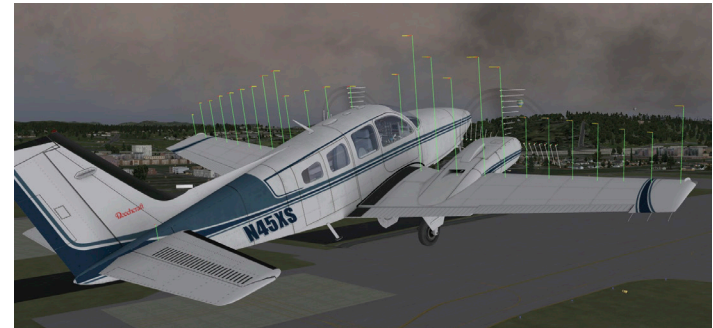
Abbildung 5.7: Darstellung der auf eine Baron 58 wirkenden Kräfte
