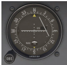
Abbildung 7.3: Der CDI (Course Deviation Indicator) in der Cessna 172SP
