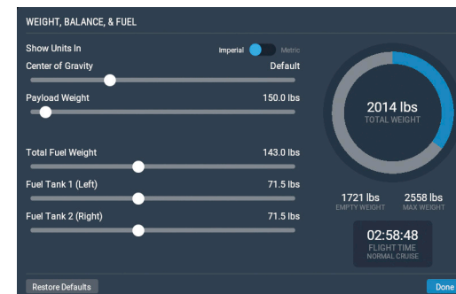
Abbildung 6.3: Zuladung, Zuladungsverteilung- und Kraftstoffanzeige für die Standard Cessna 172
