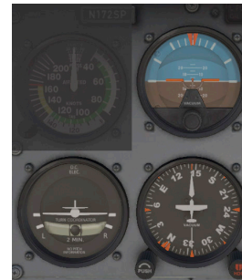
Abbildung 7.4: Die drei Primärkreiselinstrumente in der Cessna 172
