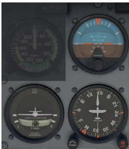
Figura 7.4: Los tres instrumentos giroscópicos primarios en la Cessna 172
