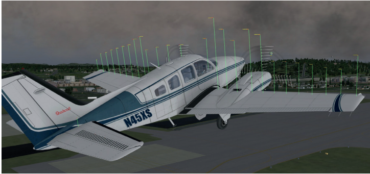
Figura 5.7: Ilustración de fuerzas actuando en una Baron 58
